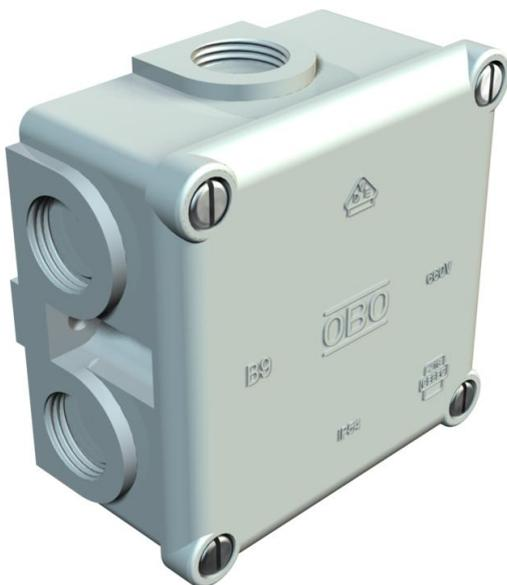
Indice de protection IP54, tension nominale 660 V, section nominale 2,5 - mm<sup>2</sup>, 2 trous de fixation pour vis jusqu'à 5 mm de Ø sur la face extérieure du boîtier, 4 vis pour couvercle, 7 entrées défonçables avec filetage M20 x 1,5,, de préférence pour presse-étoupes à filetage court.
