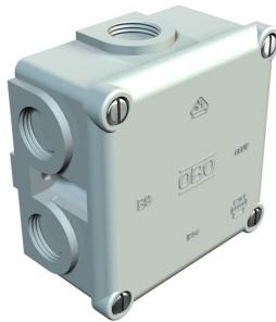
Grado di protezione IP54, tensione nominale 660 V, sezione nominale 2.5 - mm², 2 fori di fissaggio per viti di  $\varnothing$  fino a 5 mm nella parte esterna della scatola, 4 viti di copertura, 7 fori entrate cavi apribili con filettatura M20 x 1,5, preferibilmente per pressacavi aventi attacco filettato corto.
