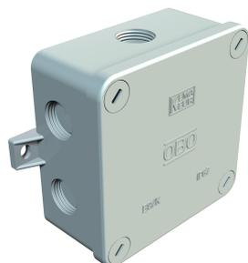
Schutzart IP67, Leerkasten zur Verwendung mit Einzelklemmen, 4 Deckelschrauben aus Kunststoff, daher absolut korrosionssicher, 2 BefestigungsfüÙe für Schrauben bis 5 mm Ø, 7 ausbrechbare Einführungen mit Gewinde M20 x 1,5. 3 Kabelverschraubungen aus Polyamid für Kabeldurchmesser von 9-12 mm Typ 106 M.
