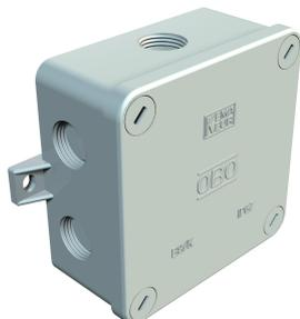
Grado di protezione IP67, scatola vuota per l'impiego con morsetti singoli, 4 viti di copertura in plastica, quinti totalmente anticorrosione 2 piedi di fissaggio per viti di Ø fino a 5 mm, 7 fori entrate cavi apribili con filettatura M20 x 1,5, 3 pressacavi in poliammide per cavi di diametro di 9-12 mm tipo 106 M.
