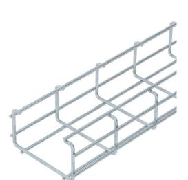
Passerella grigliata con forma a C composta da fili in acciaio saldati a punto, altezza del bordo 50 mm. Schermatura magnetica 15 dB.
