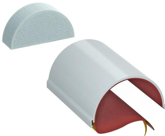
Demi-tube avec revêtement intérieur pouvant être entièrement garni de câbles et de tubes d'installation électrique. Utilisation en intérieur. Produit de construction marqué CE, agréé en Europe selon ETA-13/0904 et bénéficiant de l'homologation générale allemande du modèle. Résistance au feu jusqu'à 120 minutes.
