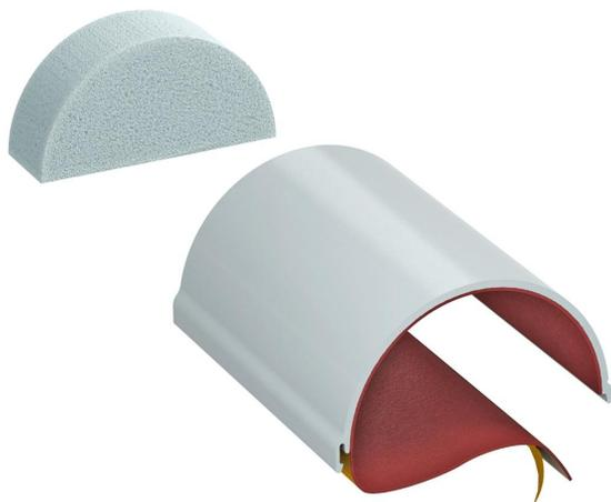
Tubo antincendio rivestito internamente che all'interno può essere riempito completamente da cavi e tubi per installazioni elettriche. Utilizzo in ambiente interno. Prodotto edile omologato per l'Europa con marchio CE secondo ETA-13/0904 e omologazione generica federale tedesca. Resistenza al fuoco fino a 120 minuti.
