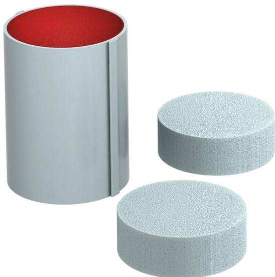
Guscio di tubo con rivestimento interno con chiusura a innesto. Interno con possibilità di riempimento completo con cavi e tubi per installazioni elettriche. Utilizzo in ambiente interno. Prodotto edile omologato per l'Europa con marchio CE secondo ETA-13/0904 e omologazione generica federale tedesca. Resistenza al fuoco fino a 120 minuti.
