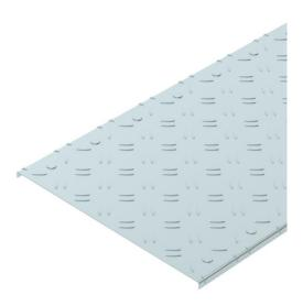
Riffelblechdeckel für das begehbare Kabelrinnen-System Typ BKR. Die Deckelstärke setzt sich aus 2,0 mm bandverzinktem Stahlblech und 1,3 mm Riffelhöhe zusammen.
