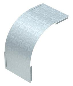
Couvercle pour coudes verticaux convexes d'une hauteur latérale de 110. La fixation est assurée par le chevauchement du couvercle de chemin de câbles. Pour plus de solidité, le couvercle peut être fixé avec des clips de fixation pour couvercle.
