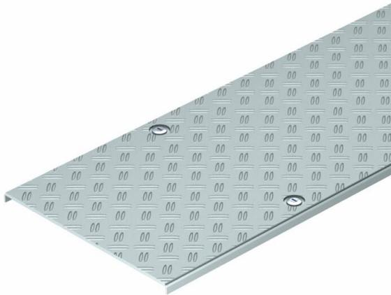
Coperchio passerella portacavi per sistemi calpestabili BKRS. Copertura della base zincata con uno spessore del materiale di 2 mm con una piastra di controllo in alluminio rivettata aggiuntiva come motivo a duetto con uno spessore del materiale di 4 mm, antiscivolo e antiscivolo. Chiusura a un quarto di giro con una distanza di un quarto di giro di 500 mm.
