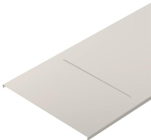
Coperchio a scatto per passerelle grigliate. Protegge cavi e linee contro danneggiamenti, impurità e umidità dall'alto. Per industria alimentare e chimica. Con nervature trasversali da largh. 400 mm. Se i coperchi vengono usati all'esterno, in alcuni casi è necessario prendere misure supplementari contro gli effetti del vento.
