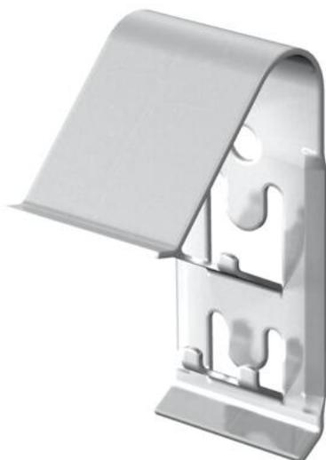
Clip fissaggio coperchio per il fissaggio universale di coperchi su passerelle portacavi, passerelle grigliate e passerelle AZ. A seconda della larghezza della passerella, per un fissaggio sicuro del coperchio di 3 m, vengono utilizzate 4 - 6 clip. Per l'impiego con passerelle grigliate con altezza laterale di 35 mm la clip blocca coperchio non è idonea.
