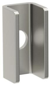
Distanziatore per l'impiego nei profili trapezoidali tipo TP. Il distanziatore viene sempre applicato per ragioni statiche, per fare in modo che il profilo non si deformi durante il serraggio delle viti di fissaggio.
