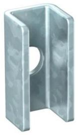
Distanziatore per l'impiego nei profili trapezoidali tipo TP. Il distanziatore viene sempre applicato per ragioni statiche, per fare in modo che il profilo non si deformi durante il serraggio delle viti di fissaggio.
