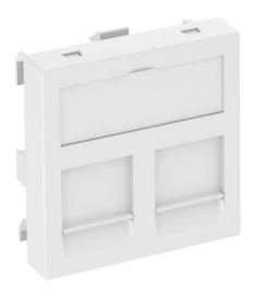
Supporto per modulo di collegamento dati con uscita diritta e chiusura per la presa di due moduli di collegamento per tecnica per dati con presa RJ45. Il fissaggio a incastro è adatto per l'incasso orizzontale e verticale dei dispositivi. Il tipo RM è dotato di un alloggiamento speciale ed è progettato per il fissaggio indiretto dei moduli di collegamento nell'apertura di montaggio.
