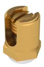
Erdungsklemme zur Befestigung des Potentialausgleichleiters am Kabeltragsystem. Gewindestift M12 mit Schlitz. Geeignet für Leiterquerschnitte 4 - 50 mm². Mit Fächerscheibe und Linsenkopfschraube.
