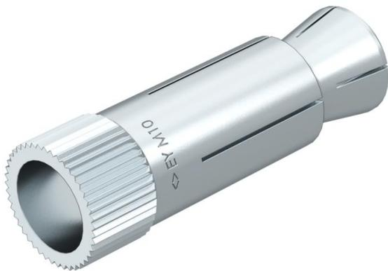
Cheville Easy pour dalle béton alvéolaire pour montage dans des panneaux de faux plafond en béton précontraint. Lors du serrage de la vis ou de l'écrou, le cône se détache de la douille d'ancrage et est tiré dans la douille. La cheville s'écarte ainsi dans l'espace vide et génère un blocage par contact mécanique. L'ancrage pour faux plafond peut également être utilisé lorsque la zone d'expansion ne se trouve pas dans un espace vide.
