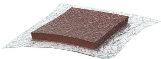
Version sous vide du bloc de mousse FBA-B200-14 pour l'obturation simple de la fente résiduelle dans le calfeutrement combiné du bloc PYROPLUG®. Une fois le montage effectué, le film est ouvert au couteau et le bloc se dilate à nouveau pour retrouver son volume initial. Le film peut rester dans le calfeutrement. Utilisation en intérieur.
