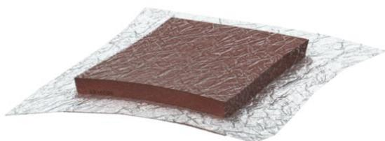
Versione imballata sotto vuoto del blocco di espansione FBA-B200-14 per la connessione semplice della colonna rimante nel blocco combinato PYRO-PLUG®. Una volta terminato il montaggio, la pellicola viene tagliata e il blocco si espande nuovamente ritornando alle sue dimensioni originarie. La pellicola può restare nell'isolamento. Utilizzo in ambiente interno.
