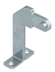
Befestigungswinkel zum Anschluss eines Flexkanals an einen Geräteeinsatz GES mit 10-mm-Bodenbelagaussparung. Maß h = 49 mm.
