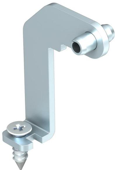
Angolare di fissaggio per il collegamento di un canale Flex a un modulo apparecchi GES con un rientro per montaggio pavimento nel coperchio di 5 mm. Dimensione h = 43 mm.
