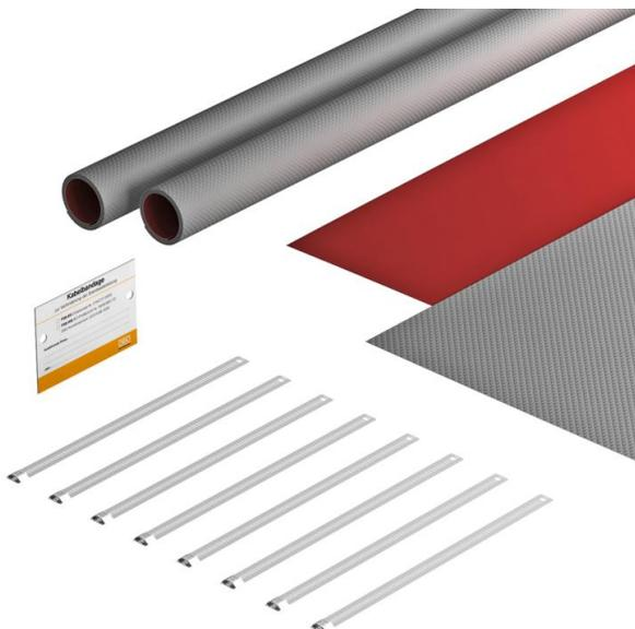
Kit complet d'enrubannage coupe-feu pour botte de câbles ou chemin de câbles sans couvercle afin de prévenir la propagation du feu. Application pour l'extérieur. Chaque kit contient 4 segments d'enrubannage résistant aux intempéries PYROWRAP® Wet, 8 colliers de serrage métalliques et une plaque d'identification. Quantité suffisante pour enrubanner une longueur d'environ 2 m de chemin de câble.
