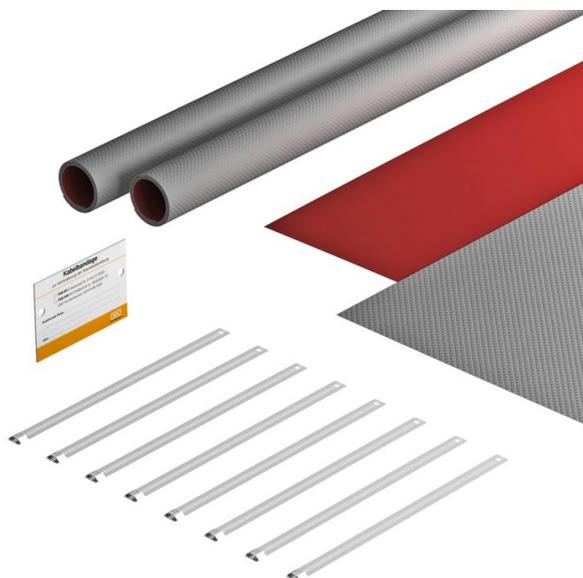
Set completo per l'inguinatura di fasci di cavi o sistemi portacavi senza coperchio per impedire la propagazione del fuoco. Applicazione all'esterno I set contengono 4 sezioni ciascuno della fasciatura cavi resistenti alle intemperie PY-ROWRAP® Wet, 8 fascette a nastro metalliche e un'etichetta da contrassegno. Sufficienti per una lunghezza di ca. 2 m.
