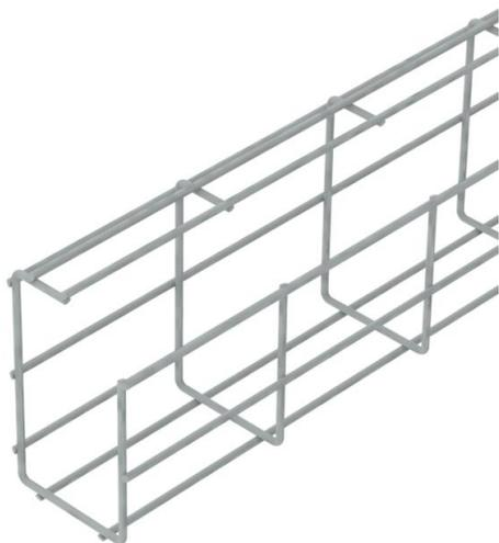
Gitterrinne in G-Form aus punktgeschweißten Stahldrähten mit unterschiedlichen Seitenhöhen und Breiten. Beschichtung mit halogenfreiem NG-10 Plascoat. Direkte Wand- und Deckenmontage möglich. Belastungsangaben zu den unterschiedlichen Verlegearten sind auf Anfrage erhältlich. Magnetische Schirmdämpfung ohne Deckel 15 dB.
