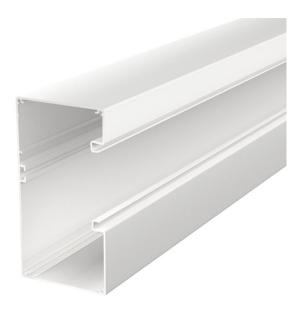
Canale di incasso apparecchi senza foratura alla base indicato per il montaggio diretto a parete o su mensole. Su richiesta possono essere realizzati anche elementi inferiori e superiori del canale con lunghezze extra, fino a 6000 mm, e anche altri colori RAL. Le superfici visibili dei canali di incasso apparecchi sono laminate
