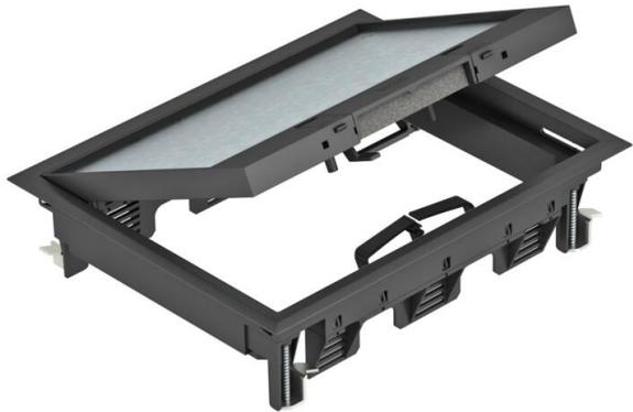
Boîtier de sol avec coulisseau d'arrêt pour 9 appareillages individuels Modul 45 au maximum dans 3 supports universels UT3, insertion dans les systèmes de goulottes et dans les faux planchers à l'intérieur.
