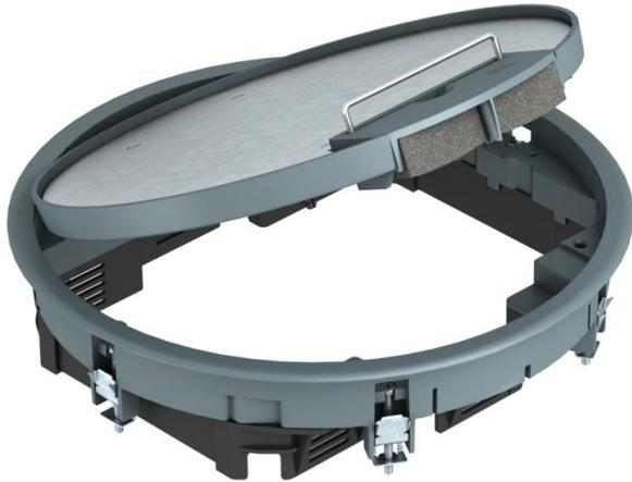
Boîtier de sol avec poignée étrier pour 10 appareillages individuels Modul 45 maximum sur 2 supports universels UT3 et un support universel UT4, insertion dans les systèmes de conduits et les faux plafonds en intérieur.
