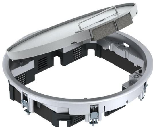
Boîtier de sol avec poignée étrier pour 10 appareillages individuels Modul 45 maximum sur 2 supports universels UT3 et un support universel UT4, insertion dans les systèmes de conduits et les faux plafonds en intérieur.
