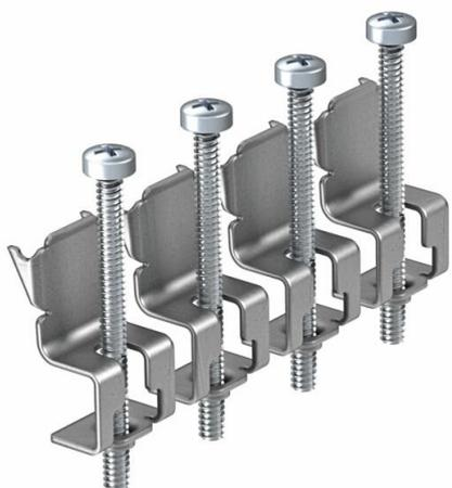
Quatre fixations universelles pour trappes d'inspection et boîtiers de sol ronds de dimensions nominales R4, R7 et R9 dans des systèmes de goulottes, des faux-planchers et planchers creux ainsi que pour trappes d'inspection et boîtiers de sol carrés de dimensions nominales 4, 6 et 9 dans des systèmes de goulottes. Huit fixations universelles sont nécessaires pour fixer le boîtier de sol GRAF9. Pièce de rechange.
