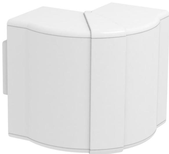
Angle extérieur variable en PC/ABS sans halogène pour changement de direction des goulottes d'appareillage Rapid 80 des systèmes GK, GKH, GS et GA. Les pièces de forme sont réglables de 80° à 100° et elles sont utilisables pour des goulottes symétriques et asymétriques. Le couvercle doit être commandé séparément.
