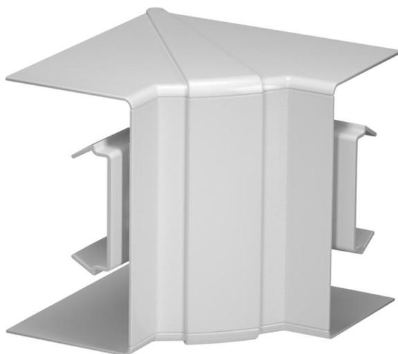
Angle intérieur variable en PC/ABS sans halogène pour changement de direction de goulotte d'appareillage Rapid 80 des systèmes GK, GKH, GS et GA. Les pièces de forme sont réglables de 85° à 95° et utilisables pour des goulottes symétriques et asymétriques.
