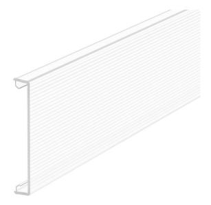
Kanaloberteil zum Verschließen der Geräteeinbaukanäle Rapid 80 GK (PVC), GS (Stahl), GA (Aluminium) und ISS Installationssäulen mit 76,5 mm Systemöffnung. Das Oberteil GK-OTKKP ist aus einem klaren, durchsichtigen PC-Material hergestellt und an der Innenseite kanelliert (Längsriefen) und eignet sich somit zur Integration von Beleuchtung in den Kanälen bzw. Säulen.
