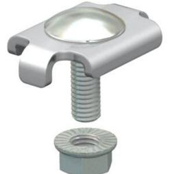
Morsetto per il fissaggio di passerelle grigliate su mensole a parete o a profilato. Inclusa vite FRS M6  $\times$  20 con dado e rondella. Inclusa vite FRS M6  $\times$  20 con dado e rondella.
