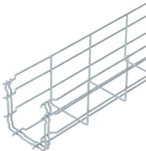
Passerella grigliata con giunto sagomato con bordo di altezza pari a 105 mm. Per la passerella grigliata non sono necessari ulteriori componenti di collegamento, vengono semplicemente inserite l'una nell'altra. La dimensione delle maglie è di 50 x 100 mm. Schermatura elettromagnetica senza coperchio 15 dB, con coperchio 25 dB.
