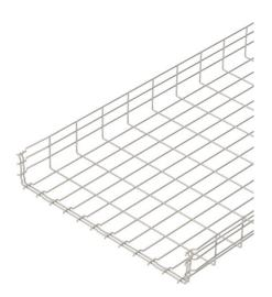
Passerella grigliata con giunto sagomato con bordo di altezza pari a 105 mm. Per la passerella grigliata non sono necessari ulteriori componenti di collegamento, le due estremità vengono semplicemente inserite una nell'altra. La dimensione delle maglie è di 50 x 100 mm. Schermatura elettromagnetica senza coperchio 15 dB, con coperchio 25 dB.
