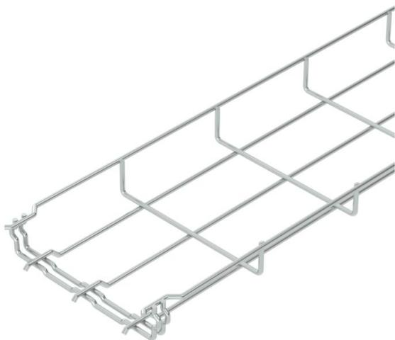
Passerella grigliata con giunto sagomato e altezza laterale di 35 mm. Per la passerella grigliata non sono necessari ulteriori componenti di collegamento, le due estremità vengono semplicemente inserite una nell'altra. La larghezza della maglia è di 50 x 100 mm (eccezione GRM 35/50 = 20 x 100 mm). Schermatura elettromagnetica senza coperchio 15 dB, con coperchio 25 dB.
