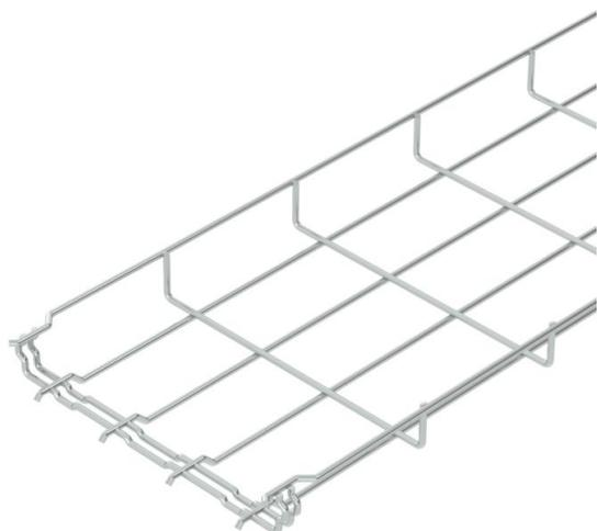
Passerella grigliata con giunto sagomato e altezza laterale di 35 mm. Per la passerella grigliata non sono necessari ulteriori componenti di collegamento, le due estremità vengono semplicemente inserite una nell'altra. La larghezza della maglia è di 50 x 100 mm (eccezione GRM 35/50 = 20 x 100 mm). Schermatura elettromagnetica senza coperchio 15 dB, con coperchio 25 dB.
