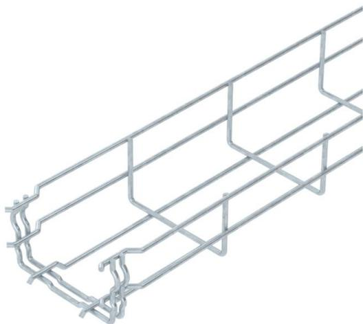
Passerella grigliata ad innesto rapido con altezza 55 mm. Per la passerella grigliata non sono necessari ulteriori componenti di collegamento, le due estremità vengono semplicemente inserite una nell'altra. La larghezza della maglia è di 50 x 100 mm (eccezione GRM 55/50 = 20 x 100 mm). Schermatura elettromagnetica senza coperchio 15 dB, con coperchio 25 dB.
