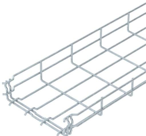
Passerella grigliata ad innesto rapido con altezza 55 mm. Per la passerella grigliata non sono necessari ulteriori componenti di collegamento, le due estremità vengono semplicemente inserite una nell'altra. La larghezza della maglia è di 50 x 100 mm (eccezione GRM 55/50 = 20 x 100 mm). Schermatura elettromagnetica senza coperchio 15 dB, con coperchio 25 dB.
