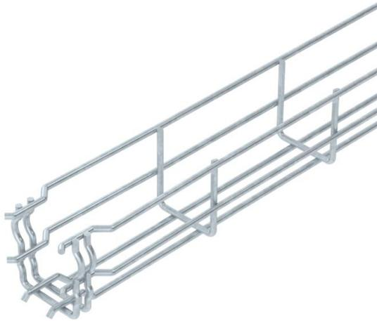
Passerella grigliata ad innesto rapido con altezza 55 mm. Per la passerella grigliata non sono necessari ulteriori componenti di collegamento, le due estremità vengono semplicemente inserite una nell'altra. La larghezza della maglia è di 50 x 100 mm (eccezione GRM 55/50 = 20 x 100 mm). Schermatura elettromagnetica senza coperchio 15 dB, con coperchio 25 dB.
