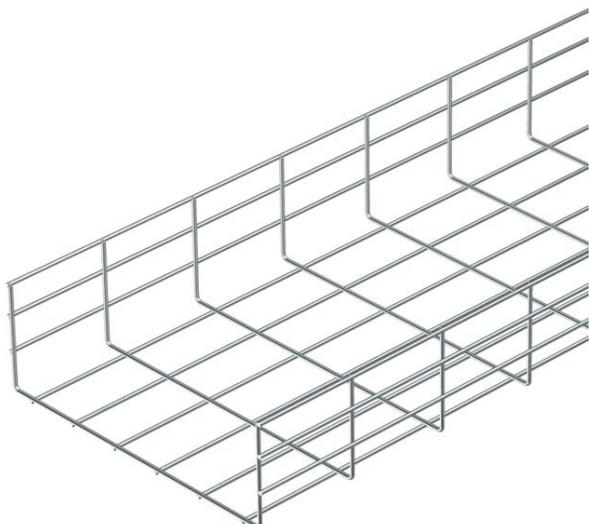
Passerella grigliata composta da fili in acciaio saldati a punto con bordo di altezza pari a 105 mm. Rivestita con Plascoat NG-10, privo di alogeni. La dimensione delle maglie è 50 x 100 mm e le larghezze 100 - 600 mm.
