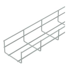
Gitterrinne aus punktgeschweißten Stahldrähten mit der Seitenhöhe 55 mm. Die Maschenweite beträgt 50 x 100 mm bei den Breiten 100 - 400 mm. Magnetische Schirmdämpfung ohne Deckel 15 dB, mit Deckel 25 dB.
