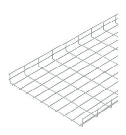
Passerella grigliata composta da fili in acciaio saldati a punto con bordo di altezza pari a 55 mm. Rivestita con Plascoat NG-10, privo di alogeni. La dimensione delle maglie e 50 x 100 mm de le larghezze 100 - 600 mm. Schermatura elettromagnetica senza coperchio 15 dB, con coperchio 25 dB.
