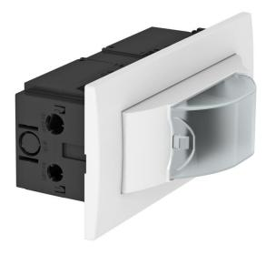
Bloc de montage pour accueillir des équipements de protection comme des automates de sécurité ou des disjoncteurs FI jusqu'à 2 TE, adaptée pour le montage dans des goulottes d'appareillage Rapid 80 et de colonnes d'installation ISS.
