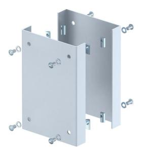
Protezione meccanica della colonna industriale ISS nell'area del pavimento. Nella fornitura sono compresi 2 profili di protezione a U in lamiera d'acciaio da 3 mm e 8 viti di fissaggio con blocchi scanalatura per il montaggio sul profilo della colonna.
