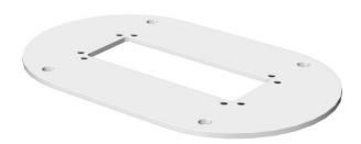
Bodenplatte mit 30 mm sichtbarem Rand und 4 Befestigungslöchern  $\varnothing$  8,5 mm. Die Bodenplatte eignet sich zur Montage von Installationssäulen vom Typ ISST70140, ISSOG70140 und ISST70140B.
