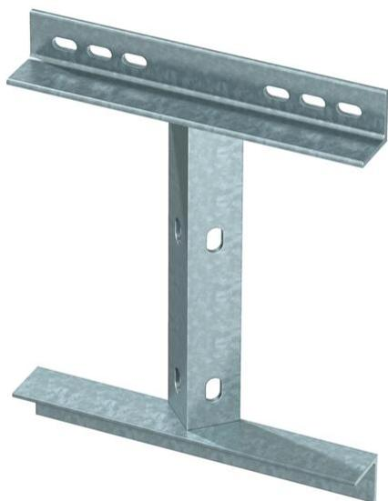
Plaque d'adaptation avec trous oblongs pour fixation universelle sur poutres métalliques verticales (IPN) et sur murs. Des consoles murales à talon sont vissées sur la plaque d'adaptation à un angle de 45°. Pour le supportage des chemins de câbles dans les angles de bâtiment et passages particuliers. Pour le montage de la console sur la plaque d'adaptation, utiliser la vis à tête hexagonale type SKS 12x40 GF. Veuillez commander la quantité nécessaire séparément.
