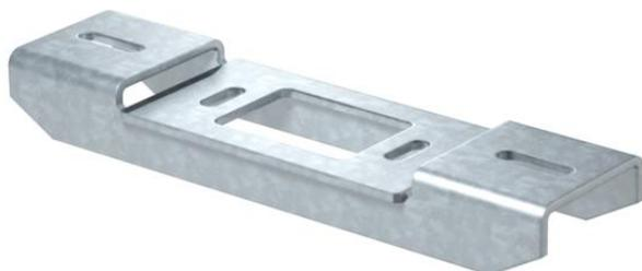
Piastra di rinforzo per supporto a soffitto in versione simmetrica per l'aumento della portata con profilati di sospensione IS 8 K e US 7 K. Il supporto a soffitto dell'adattatore aumenta la portata dei profilati di sospensione tipo IS 8 K e US 7 K in relazione alle caratteristiche del tassello.
