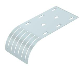
Tôle de sortie de câble pour chemins de câbles en treillis. La tôle de sortie de câble permet de respecter des rayons de courbure définis et empêche ainsi de possibles ruptures de câbles. À monter dans le sens longitudinal ou latéral, à relier en rangée pour les grandes largeurs.
